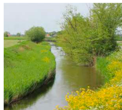
Een waterloop met getrapt schuin profiel aan een zijde via De Polders mee-maken
